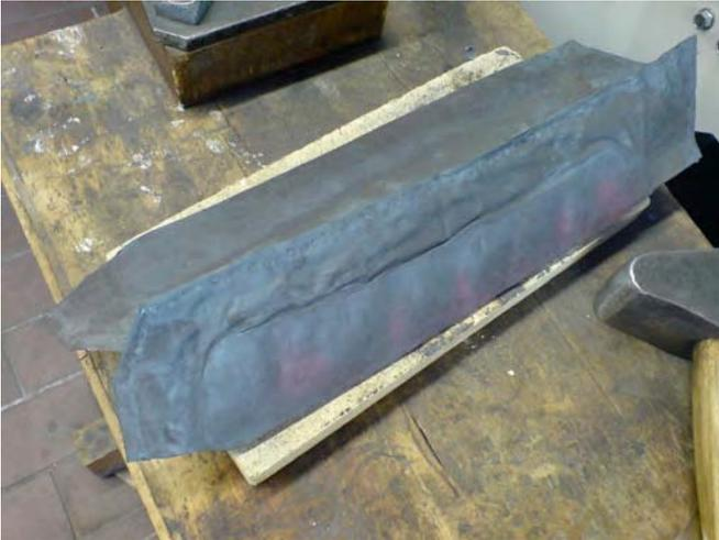
Dann wird noch 4 mal auf ca. 860°C erhitzt und mit Druckluft auf Dunkelrot (700°C) abgekühlt, das letzte mal dann bei ruhender Luft in der Tüte - das sorgt für ein feines entspanntes Gefüge.
