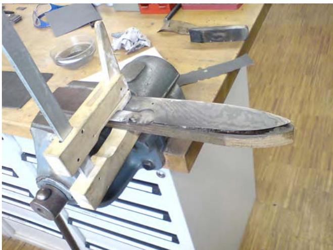
Die Klinge wird mit einer Schraubzwinde auf der eingespannten Unterlage festgeklemmt - man will sich ja nicht erstechen!
