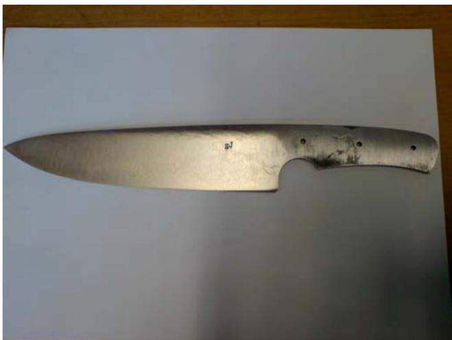
Mit einem neuen 400er Band, niedriger Geschwindigkeit, Schleiföl und VIIIEL KÜHLEN fein schleifen.
