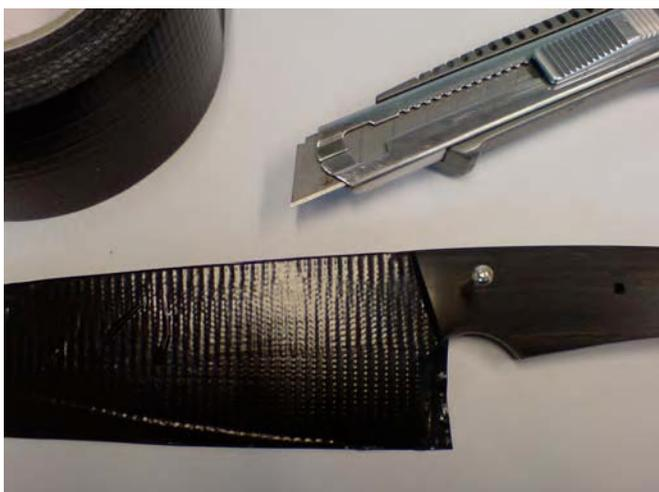
Die Klingen werden mit Tape vor Kratzern und Klebstoff geschützt - am Griff wird das Tape vorsichtig mit dem Cutter anpassen.
