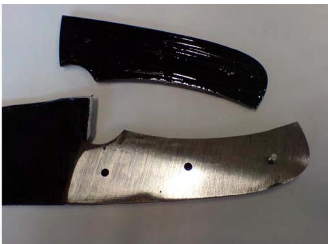
Ein Pin zur Orientierung, Kleber auf die Schalen,
