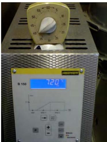
In Härtefolie einpacken und bei 720°C
