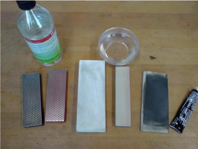
Vorschleiff mit Diamant und Petroleum, Feinschliff mit 3000er Keramikstein und Belgischem Brocken nass, Abzug auf Klavierfilz mit Polierpaste.
