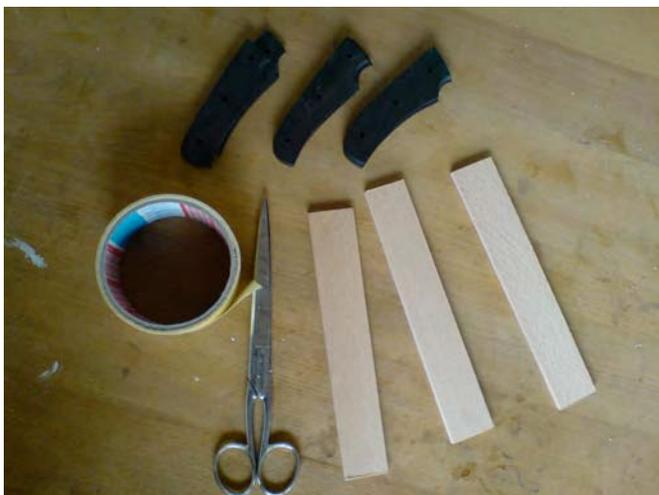
Während der Zeit werden die Griffschalen mit Doppelklebeband auf Hölzer geklebt - das schont die Finger und erleichtert die Kontrolle der Symmetrie!
