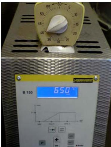
Bei 650°C 40 Min spannungsarm glühen.
