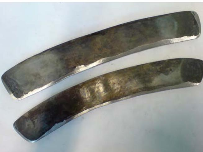
An der Schneidenseite mit der Flex anphasen (dann findet man die Schneidphase leichter - bei 0,8 - 1 mm an der Schneide ist das sehr hilfreich beim Schleifen!) Wieder verpacken
