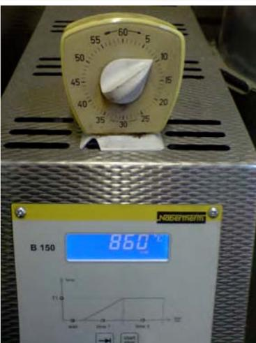
3 - 4 mal von 860°C auf 700°C mit Druckluft abkühlen,
