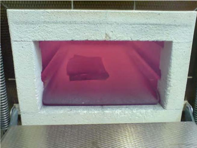
im abgeschalteten Ofen langsam auf ca. 500°C abkühlen lassen, um ein spannungsarmes (weiches) Gefüge zu erhalten,
