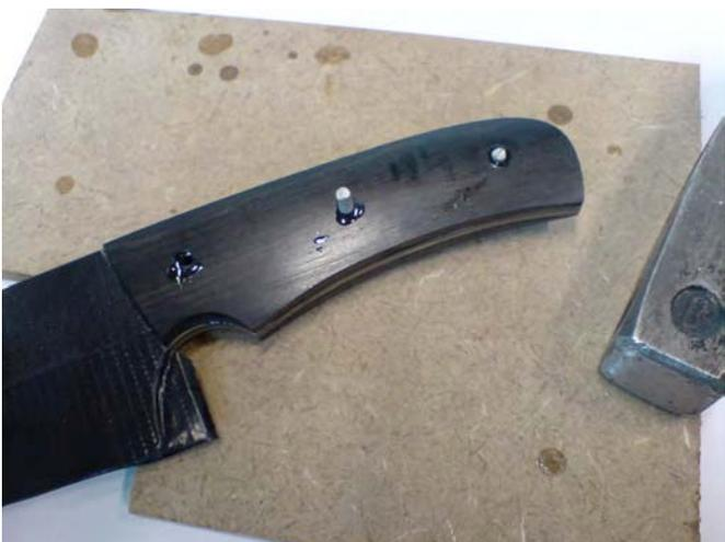
dann die 2. Schale und die restlichen Pins montieren.
