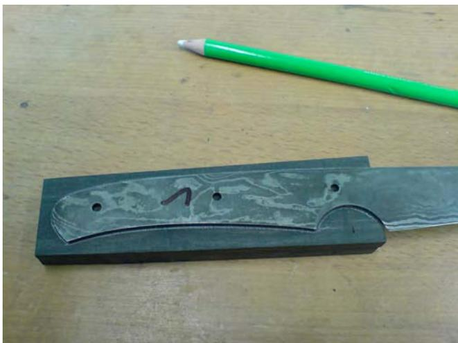
Umriss anzeichnen und die Schalenpaare / Messer nummerieren.
