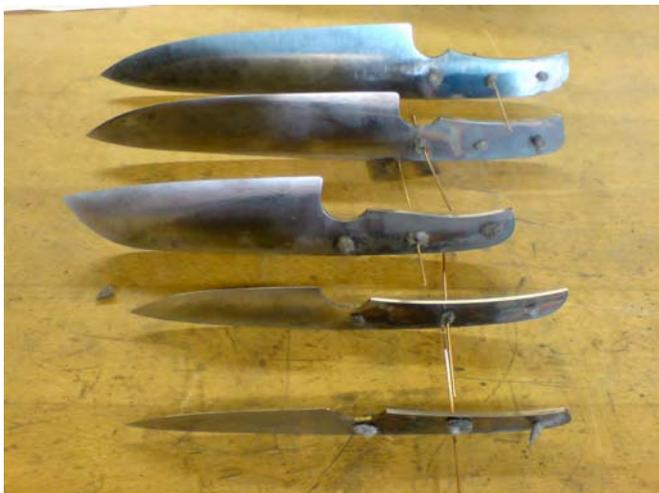
Danach wird schrittweise feiner geschliffen (180 / 240 / 400 - nur noch auf „Oberfläche“) und zum Härten vorbereitet -
