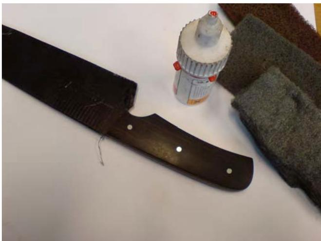
Die Griffschalen mit Schleifvlies fein schleifen, mit Sekundenkleber eventuelle Poren füllen und mit 000 Stahlwolle auf Seidenglanz abreiben.
