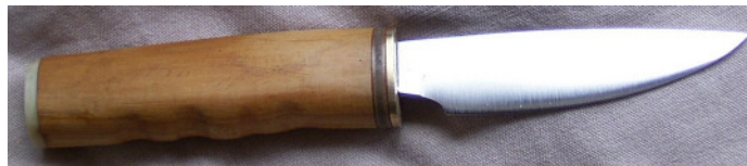
Bild 16. Messer mit einer Klinge aus 1.8159 (Klinge von Achim Wirtz hergestellt und wärmebehandelt).
