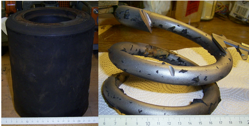
Bild 5. Schraubenfeder aus dem TEE Vt11.5, links Originalzustand, rechts entgummiert (mechanisch)
