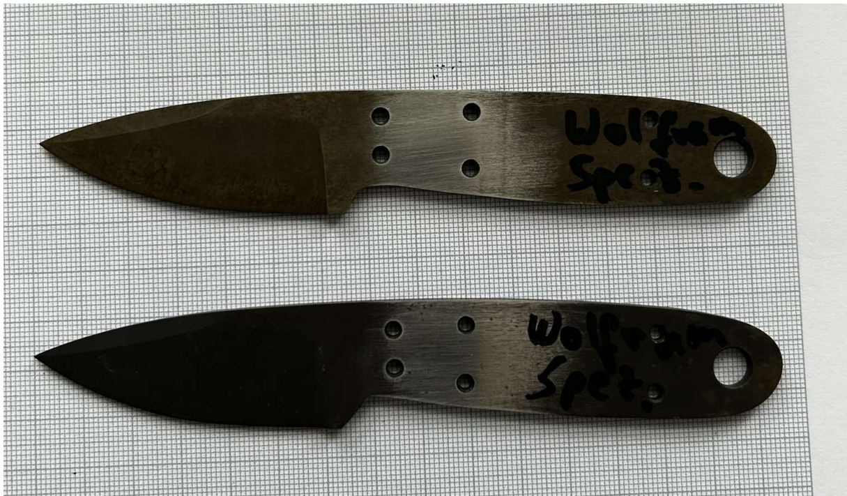
Bild 1. Zwei Klingen aus Wolfram Special mit für die Messung vorbereiteten Stellen
